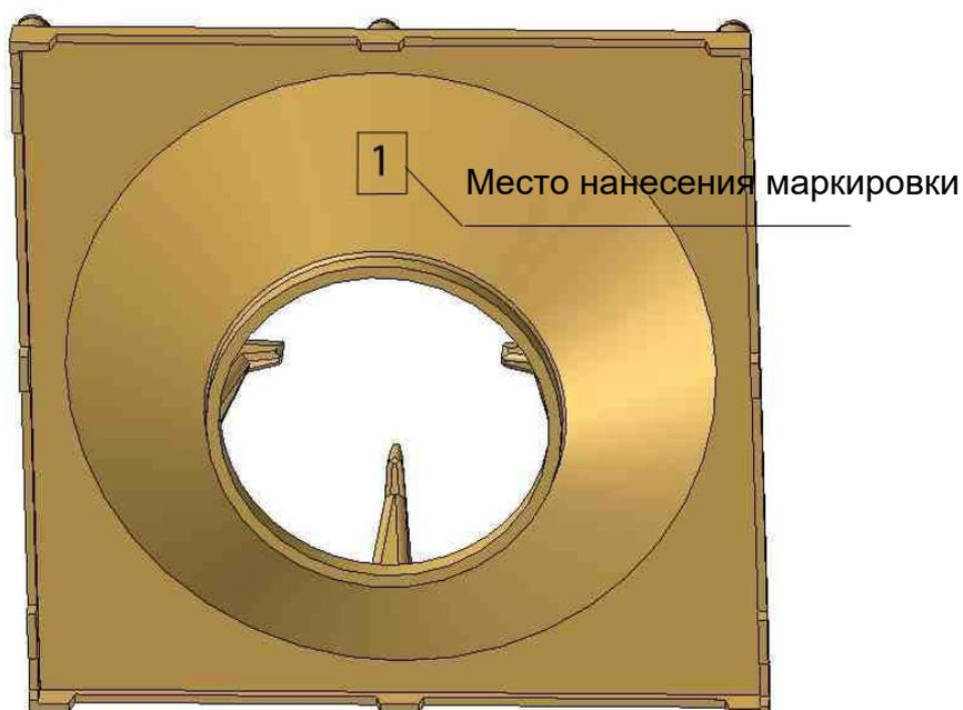
Рис. 13 Место нанесения маркировки
