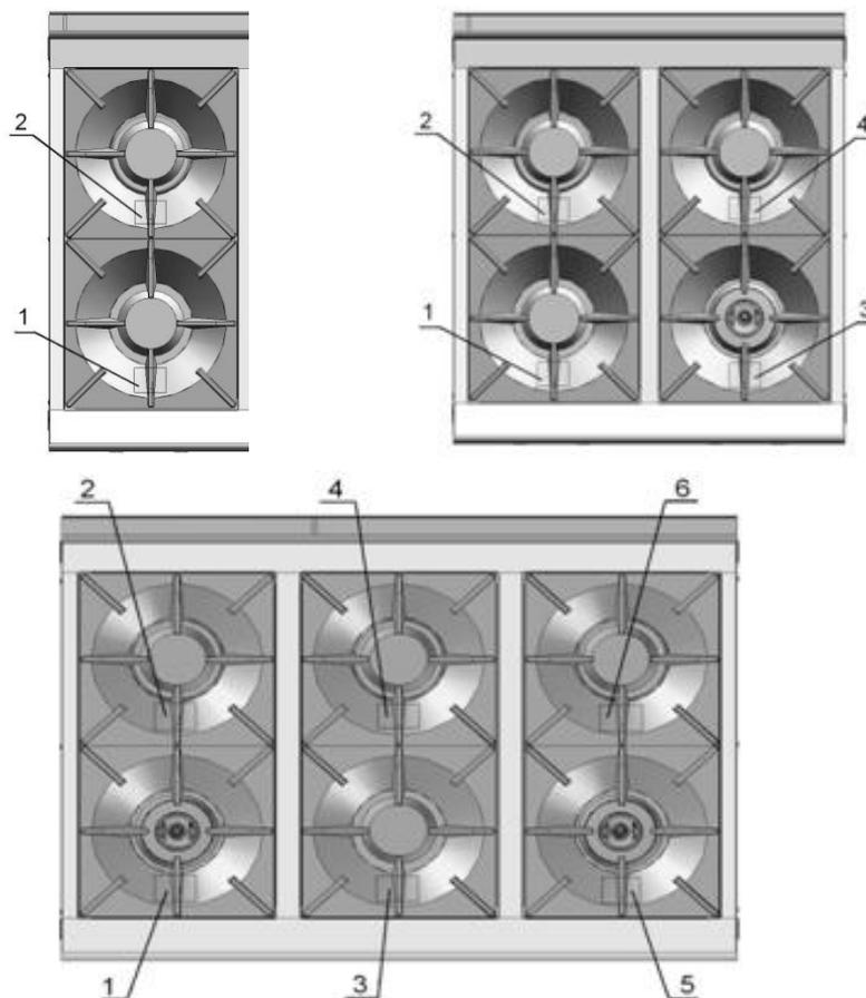
Рис 12. Схема установки и маркировка газовых решеток
